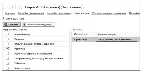
При указании значения доступа в режиме «Все запрещены», доступ к данным будет ограничен по всем значениям вида доступа кроме разрешенных.
